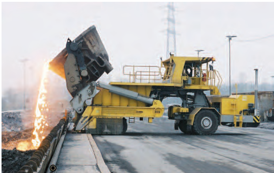
Bild 5 | Durch die Art und Geschwindigkeit der Abkühlung, wie hier in einem so genannten Schlackeboot, lässt sich die Qualität von Schlacke gezielt beeinflussen
