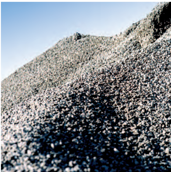
Bild 4 | LiDonit® entsteht aus der Schmelze bei der Stahlerzeugung durch Zugabe von Quarzsand und Sauerstoff.
