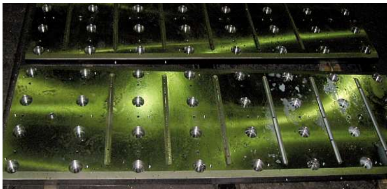
Bild 1: Mit Hilfe von Schleißplatten steigt die Lebensdauer eines Walzgerüstes. Diese Aufsätze müssen normalerweise mit viel Aufwand abgefräst werden, um einsatzfähig zu bleiben.
